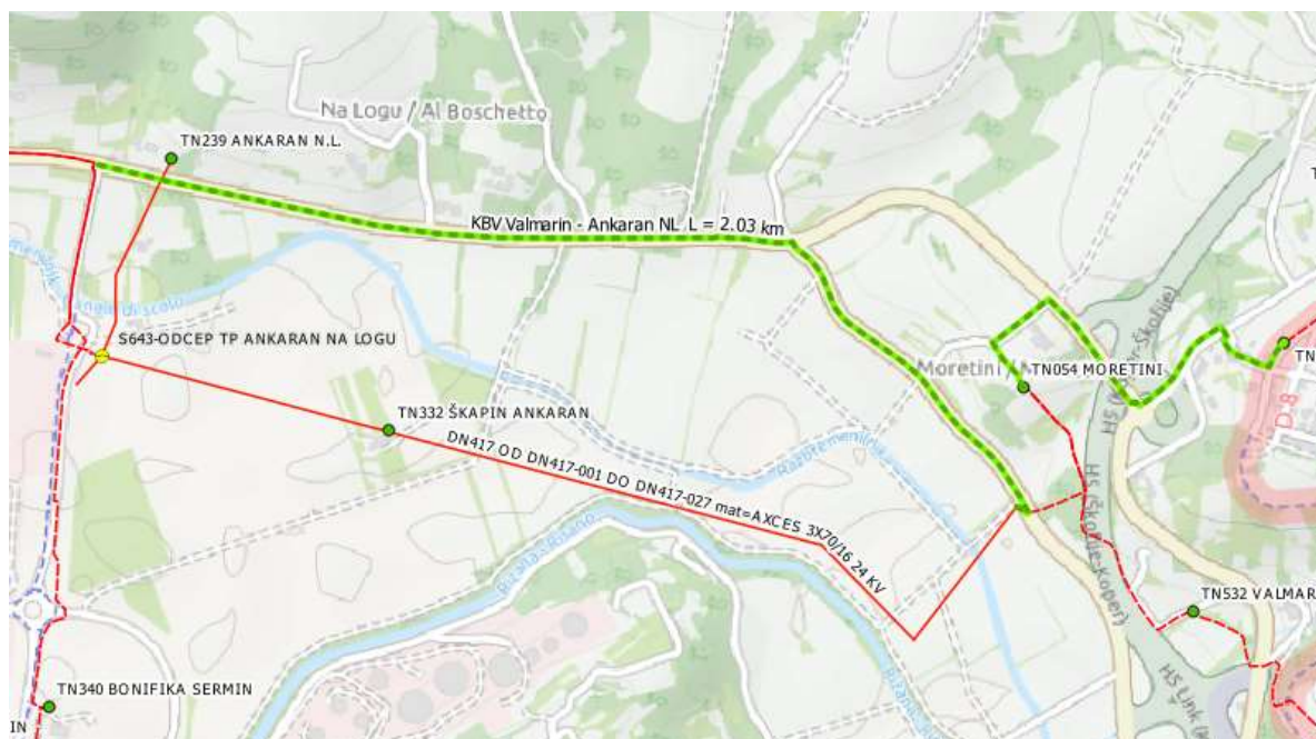
Slika 61) Kabliranje izvoda Ankaran za zagotovitev ustreznega rezervnega obratovalnega stanja.
