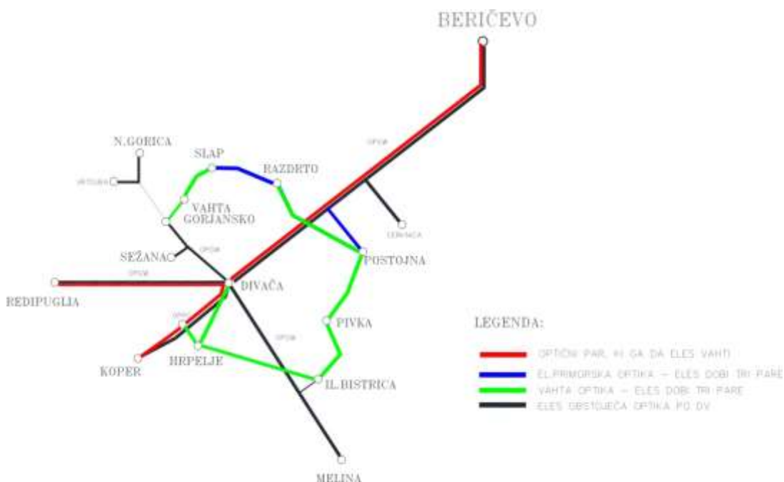
Slika 87) Končno stanje optičnega omrežja po izgradnji novih optičnih vodov
