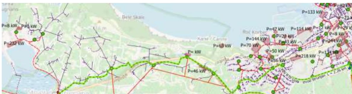
Slika 79) Predvideni potek izvoda Strunjan iz bodoče RTP 110/20 kV Izola.
